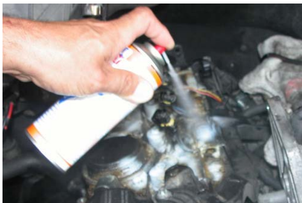
Spryskaj wszystkie zanieczyszczone elementy, pozostaw na około 30min.
