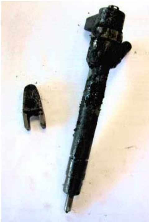
Zdemontowany wtryskiwacz pokryty warstwą twardego nagaru.
