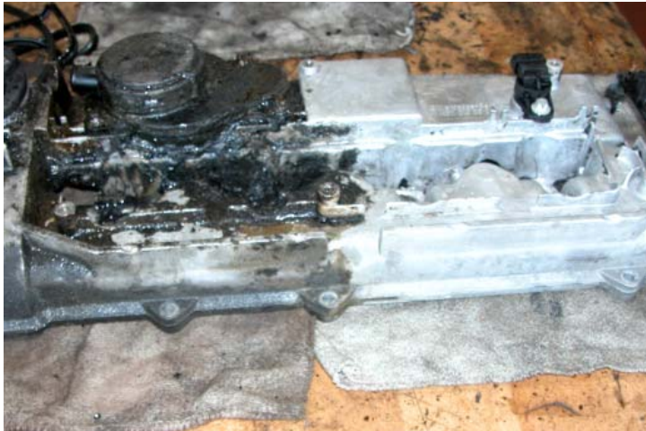
Oczyszczona pokrywa zaworów.
