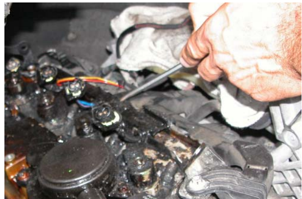
Usuń skrobakiem kolejno rozpuszczone warstwy nagaru.
